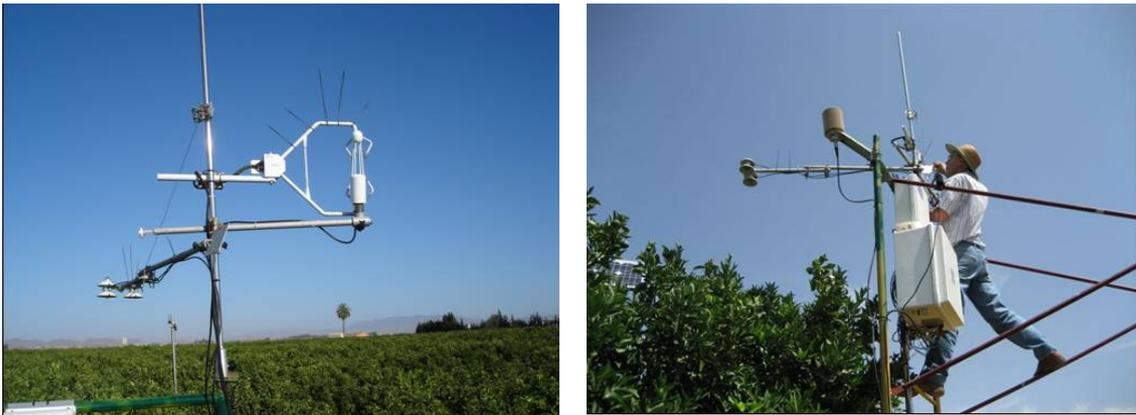
Bild 15. Ansicht des Eddy-Kovarianz-Systems (Schallanemometer, CO<sub>2</sub>- und H<sub>2</sub>O-Analysegerät) zur Messung von CO<sub>2</sub>-Fluss und Evapotranspiration, eingerichtet von der Universität Cartagena.
