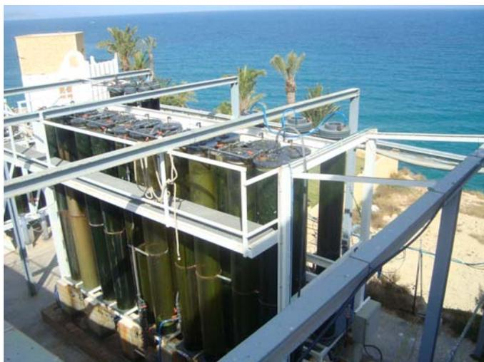
**Foto 2.** Detalle bioreactores verticales.
